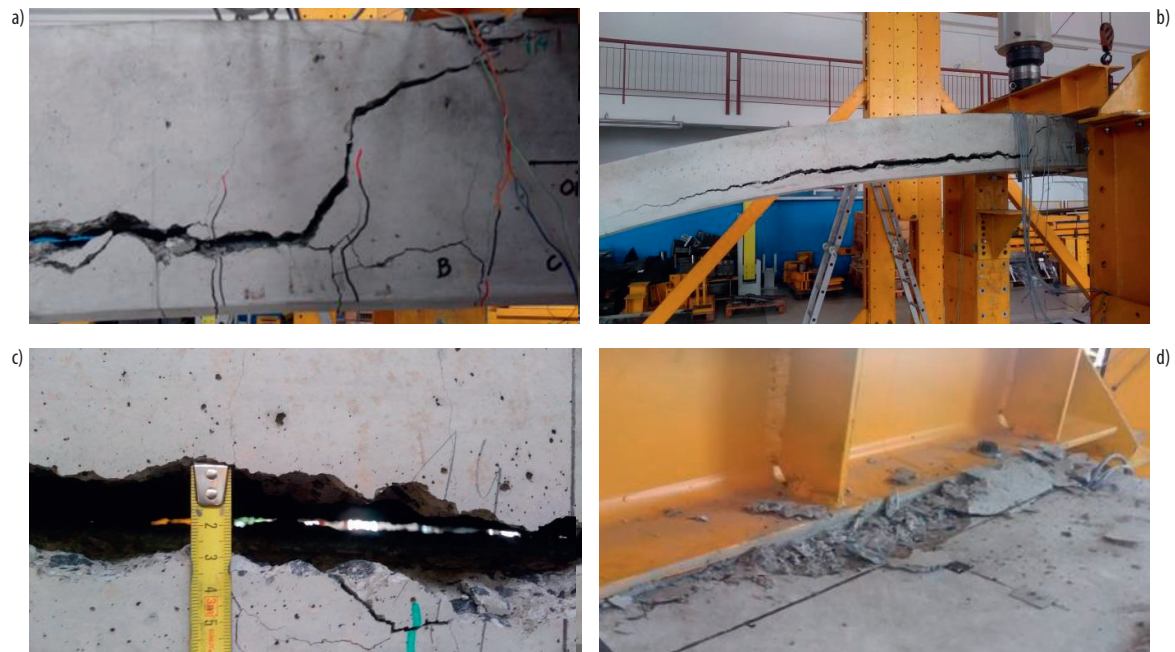
Rys. 9. Postać zniszczenia modelu LS1: a) początkowa faza pęknięcia w środku rozpiętości łuku, b) widok pęknięcia na długości elementu, c) szczegół pęknięcia, d) zmiążdżenie betonu w miejscu przyłożenia obciążenia
